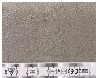
Betonoberfläche nach Herstellung mit Schalungsplatte mit Struktur
