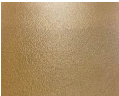
Oberfläche der Schalungsplatte mit Struktur
